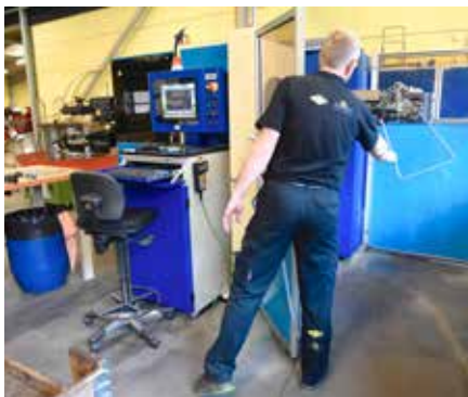
Den CNC-styrda trådbockningsmaskinen har totalrenoverats för att möta kundernas krav på komplex tredimensionell trådbockning.
